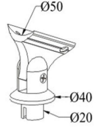
AL 101 40'lık Ay Mafsals Takımı 40'Clevis Connector Joint set
